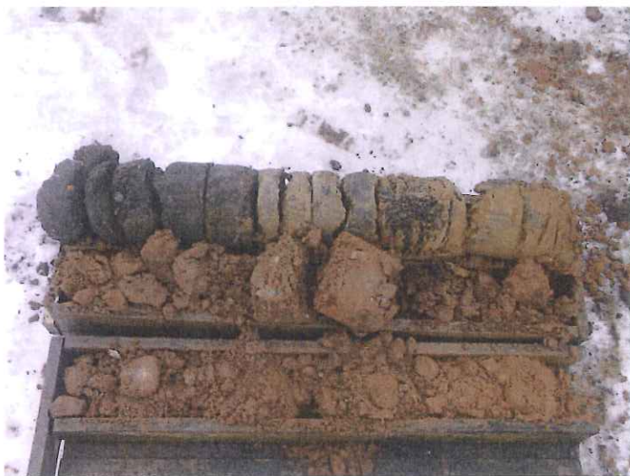
Foto č. 1: Výnos jádra zemin z průzkumné geologické sondy GS-1.
