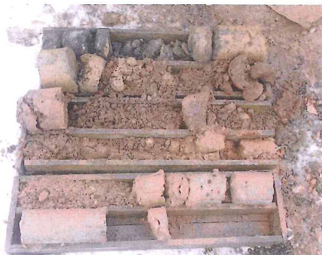
Foto č. 6: Výnos jádra zemin a hornin z průzkumné geologické sondy GS-3.
