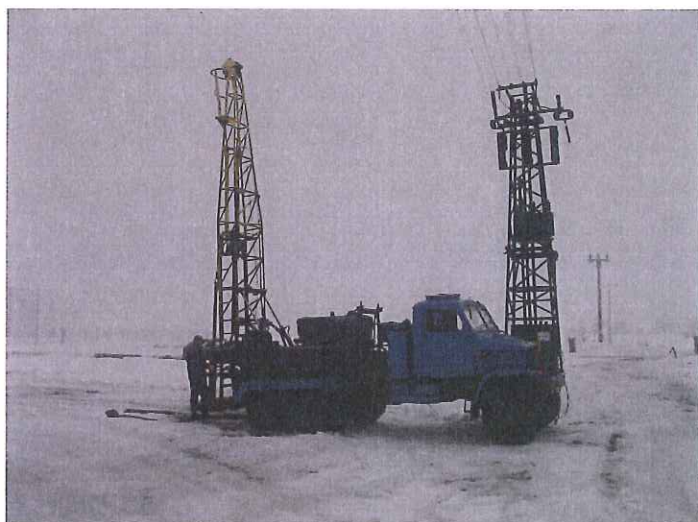
Foto č. 9: Hloubení průzkumné geologické sondy GS-5.
