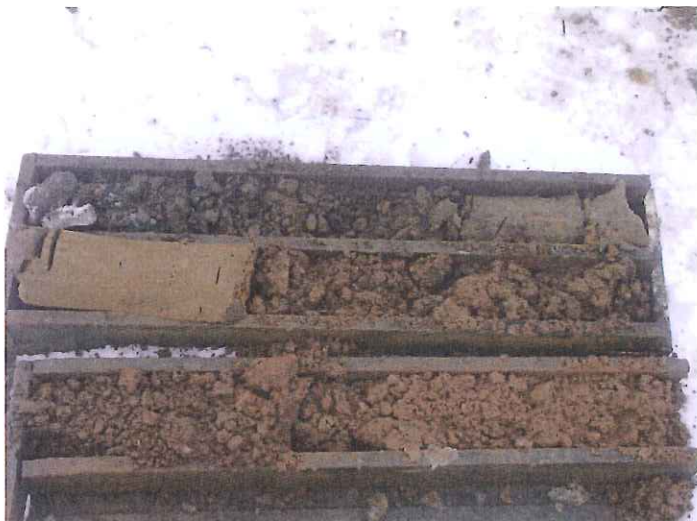
Foto č. 3: Výnos jádra zemin z průzkumné geologické sondy GS-2.
