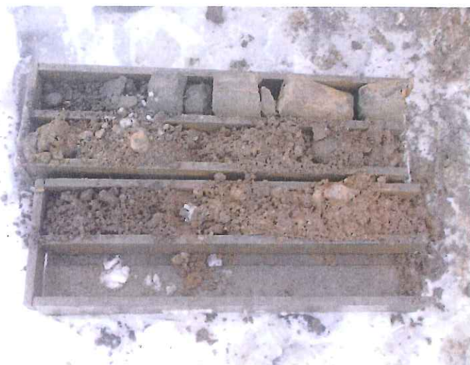
Foto č. 8: Výnos jádra zemin z průzkumné geologické sondy GS-4.
