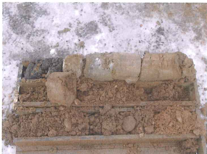
Foto č. 10: Výnos jádra zemin z průzkumné geologické sondy GS-5.
